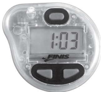
Slika 6. TEMPO TRAINER PRO – tempomat za frekvenciju zaveslaja i brzinu plivanja
